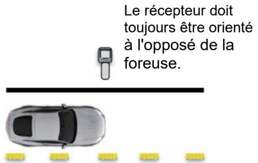
Une fois de l'autre côté, placer le récepteur directement en ligne et procéder au forage en utilisant la barre de direction droite-gauche pour maintenir la trajectoire du forage en ligne.
